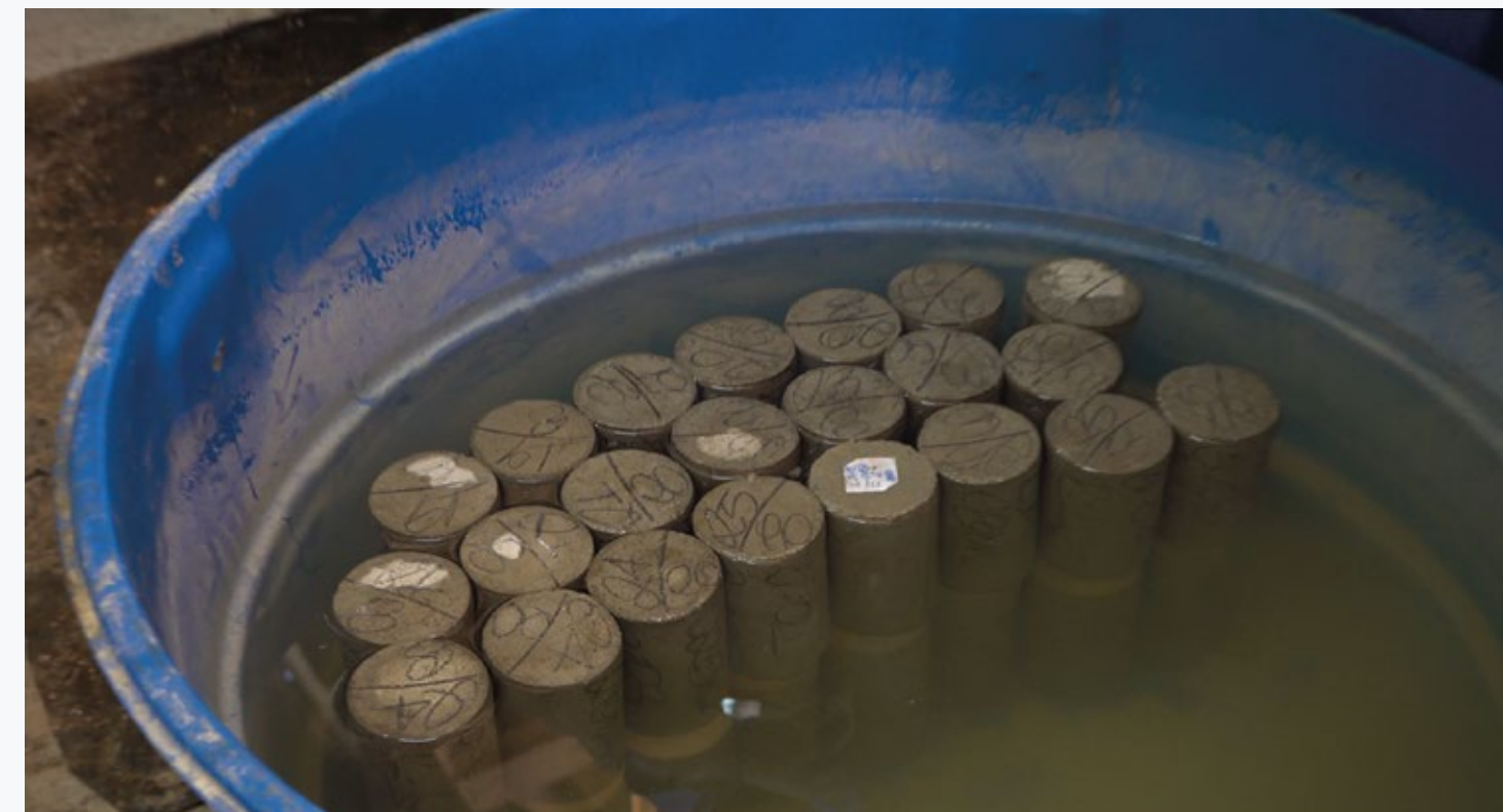
Amostras de concreto para prova em laboratório
