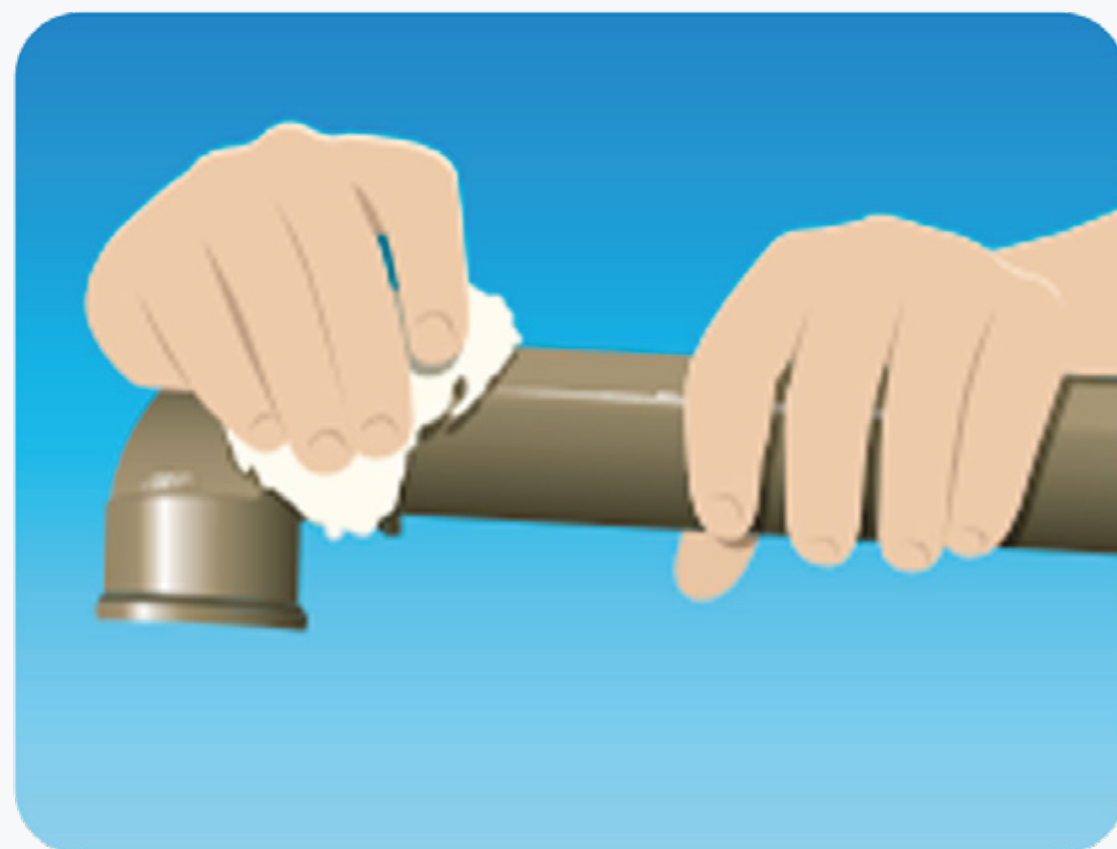
Figura 19: Remoção do excesso de Adesivo Plástico PVC
