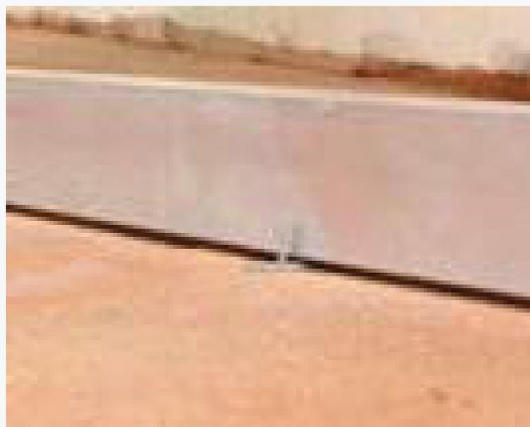
Figura 12: Caso de irregularidade. O espaçador de 2 mm coube sob a régua metálica
